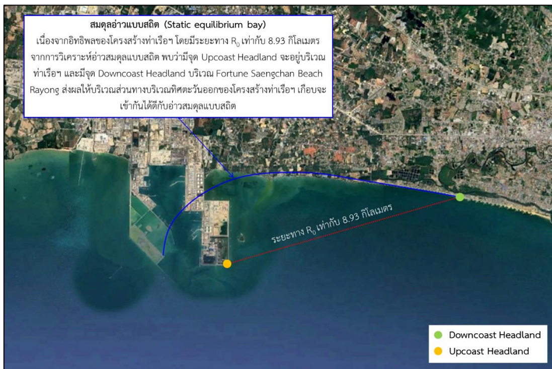
รูปที่ 4-62 หาดสมดุลอ่าวแบบสถิต (Static equilibrium bay)
