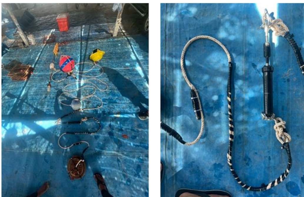
รูปที่ 4-14 ภาพถ่ายระหว่างการติดตั้งเครื่องมือตรวจวัดความเร็วและทิศทางกระแสน้ำที่ระดับกลางความลึกน้ำ ด้วยเครื่อง Electromagnetic current meter บริเวณชายฝั่งนิคมอุตสาหกรรมมาบตาพุด อ.มาบตาพุด จ.ระยอง
