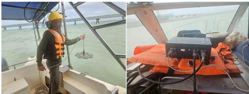
รูปที่ 4-37 ตรวจสอบค่าความลึกด้วยการทำบาร์เช็ด
