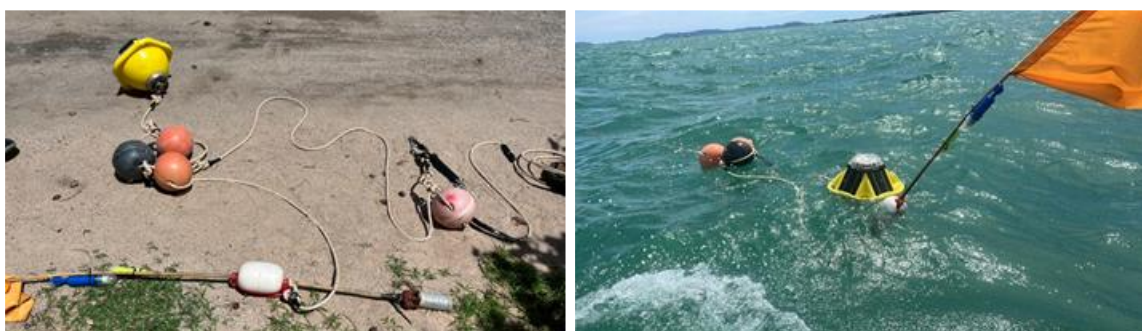
รูปที่ 4-19 ภาพถ่ายระหว่างการติดตั้งตรวจวัดคลื่น บริเวณชายฝั่งนิคมอุตสาหกรรมมาบตาพุด อ.มาบตาพุด จ.ระยอง ระหว่างวันที่ 17-18 มิถุนายน พ.ศ. 2568
