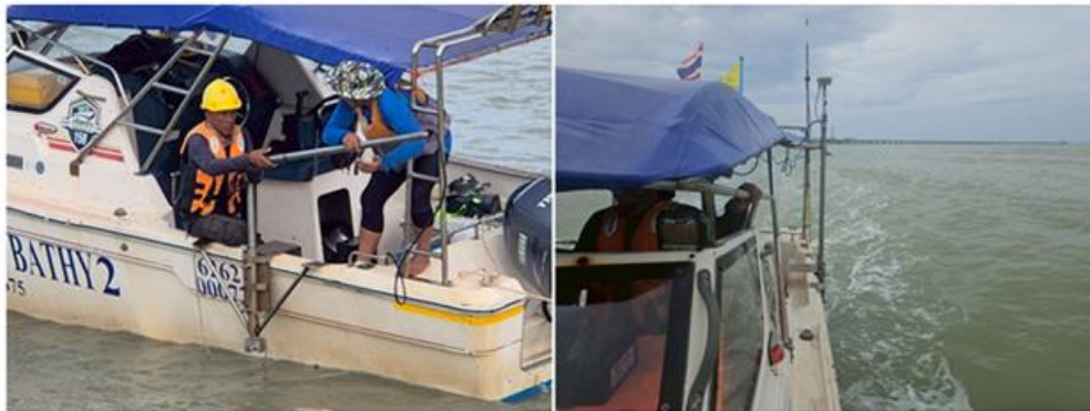
รูปที่ 4-35 ติดตั้งเสาอากาศ GNSS บริเวณท้ายเรือตำแหน่งเดียวกับหัวส่งเครื่องหยั่งน้ำ
