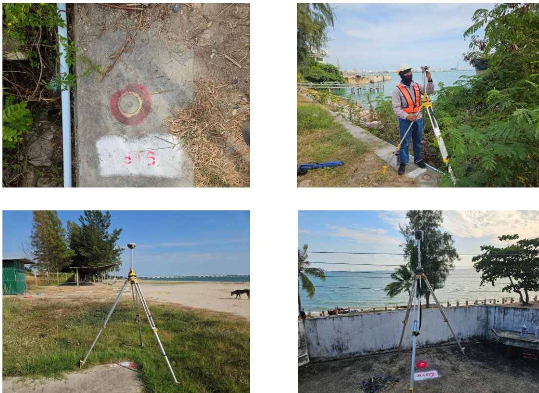
รูปที่ 4-29 (ต่อ) การรังวัดค่าพิกัดและค่าระดับด้วยเครื่องรับดาวเทียม GNSS-STATIC ฝั่งตะวันตก
