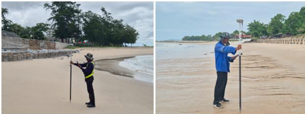
รูปที่ 4-32 สำรวจค่าระดับชายฝั่งด้วย GNSS แบบ RTK
